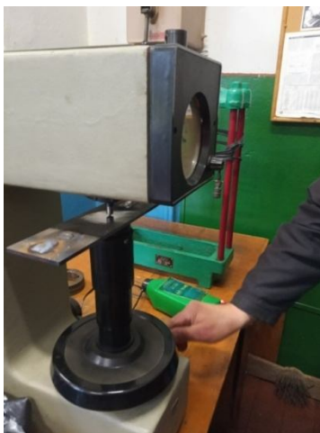
Рис. 2 – Дослідження твердості напавленого металу
