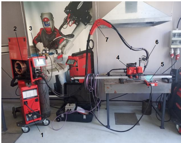
Рисунок 1 – Загальний вигляд установки для наплавлення 1 – зварювальний апарат Fronius CMT 4000 Advanced; 2 – механізм подачі електродного дроту VR 7000 CMT; 3 – пульт дистанційного керування RCU 5000i; 4 – зварювальним візком Flex Track 45 Pro; 5 – пульт FRC 45 Pro дистанційного керування візком; 6 – пальник Robacta Drive CMT; 7 – шланговим пакетом Fronius Roboter Brenner з дровтовим буфером
