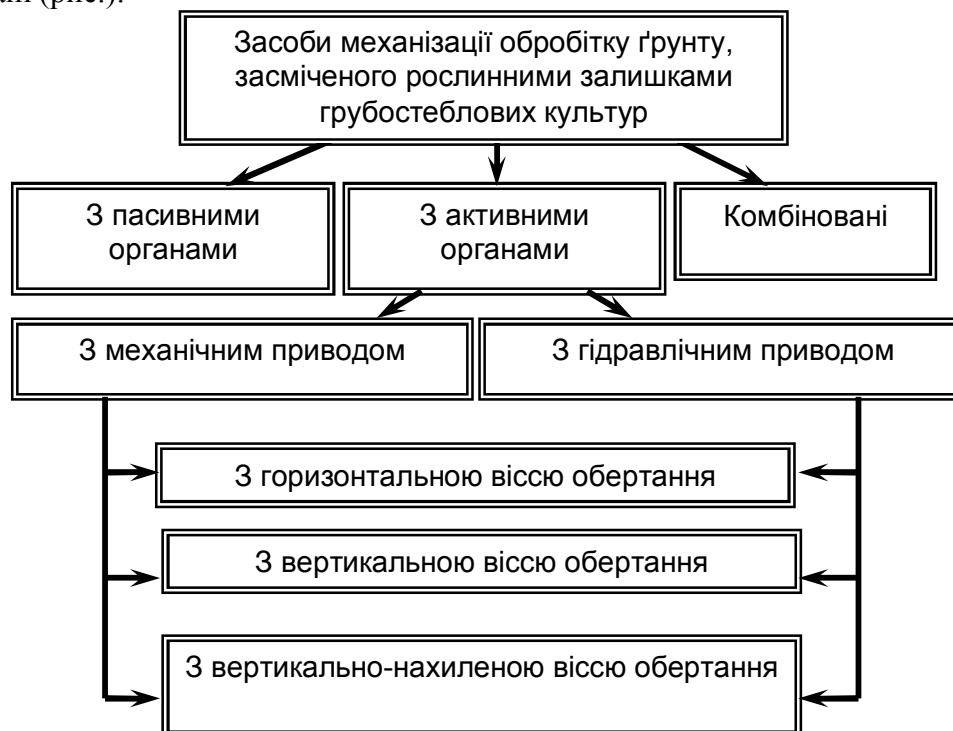
Рисунок 1 – Схема класифікації основних засобів механізації обробітку ґрунту, засміченого рослинними залишками грубостеблових культур
