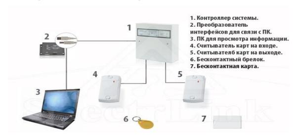
Рис. 1 — Техническое решение для электронного учета рабочего времени и стоимость (минимальный комплект поставки)
