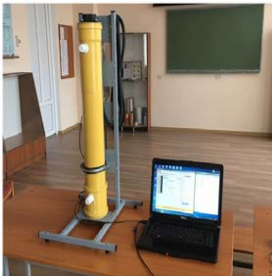
Рисунок - Тарування датчика рівня на різних видах палива
