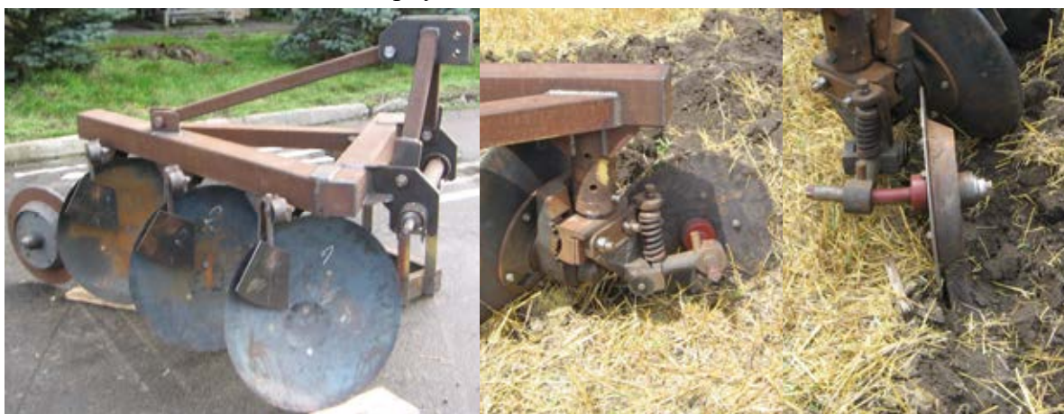
Рис. 1. Конструкція обробітку ґрунту дисковими знаряддями
