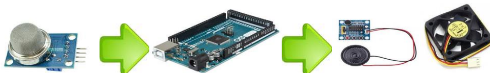
Рис. 9 Схема реалізації контролю якості повітря за датчиком MQ-135
