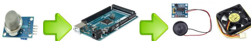
Рис. 10 Схема реалізації контролю якості повітря за датчиком MQ-8
