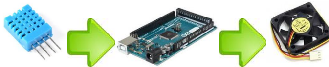
Рис. 6. Схема реалізації контролю температури повітря
