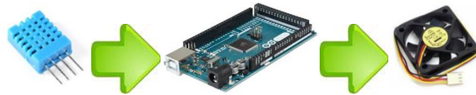
Рис. 7 Схема реалізації контролю вологості повітря
