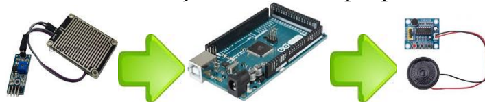
Рис. 8 Схема реалізації контролю витoku води
