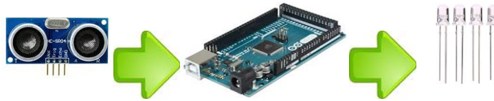
Рис. 4 Схема реалізації часткового освітлення приміщення
