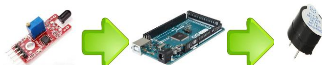
Рис. 3 Схема реалізації пожежної сигналізації
