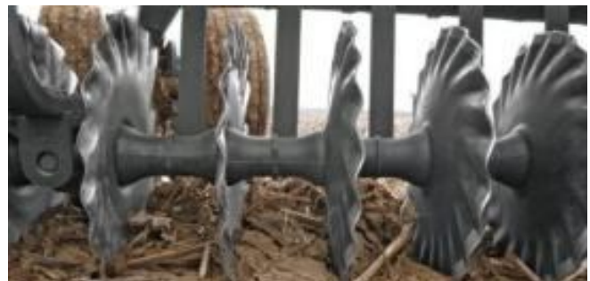
Рис. 2. Гофрований диск і батарея дисків комбінованого агрегату
