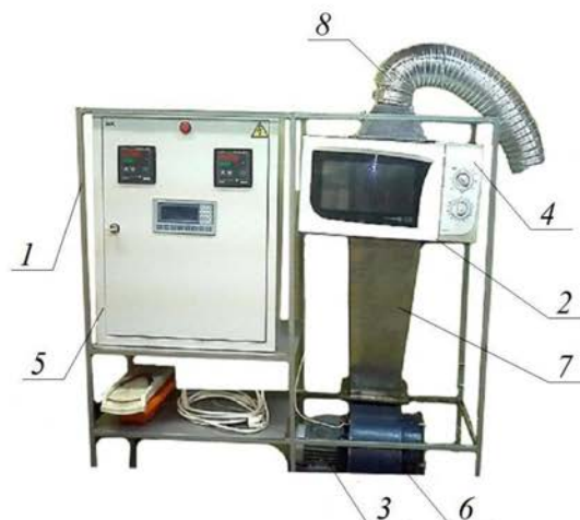
Рис. 1. Схема експериментальної установки: 1 – станина; 2 – робоча камера; 3 – електродвигун АІР 56 В4 УЗ 1Р54; 4 – блок управління; 5 – пульт автоматичного керування; 6 – нагнітальний вентилятор; 7 – нагнітальний повітрепровід; 8 – гофрований повітрепровід
