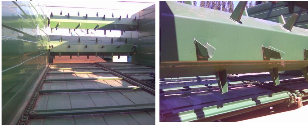
Рисунок 2 – Повздовжній транспортер і блок бітерів КТУ-10А:
