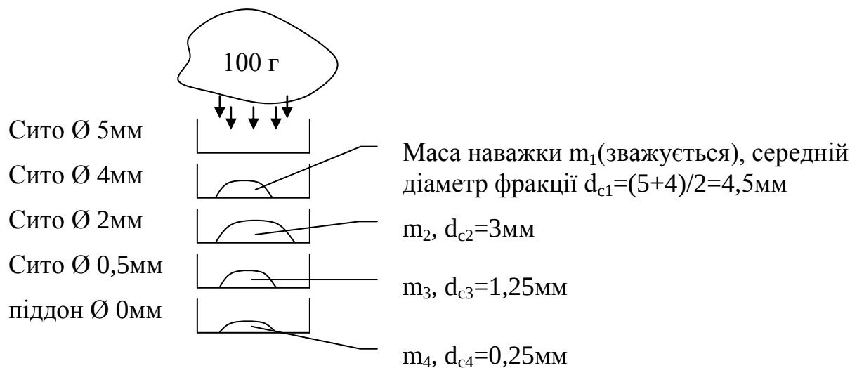
Рис. 3. Визначення параметрів дослідження при ситовому аналізі
