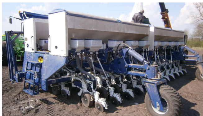
Рис. 2. Обслуживание (заправка семян и минеральных удобрений) сеялки Prime-3000.
