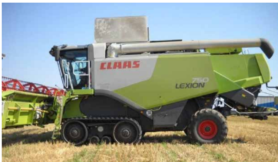
Рис. 1. зернозбиральний комбайн LEXION 750 з гусеничною ходовою системою на збиранні озимої пшениці
