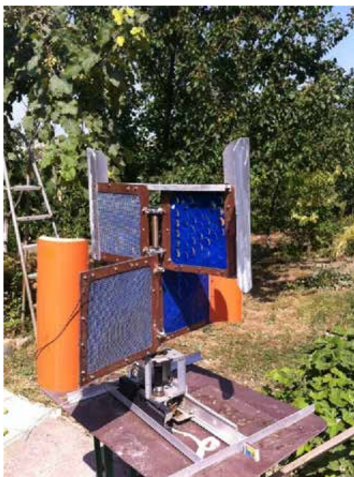
Рис. 2. Модель діючого двоярусного вітряка
