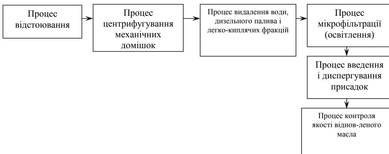
Рис. 1. Схема технологічного процесу відновлення експлуатаційних властивостей відпрацьованих масел
