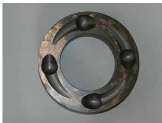
Рис. 3. Схема гвинтового конвеєра та загальний вигляд веденої півмуфти
