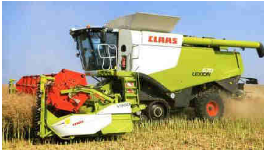
Рис. 1. Жатка для збирання зернових культур і ріпаку VARIO V900
