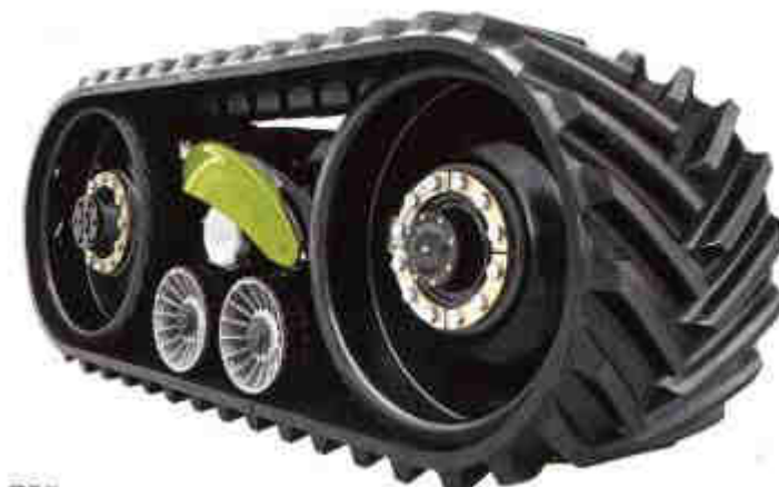
Рис. 2. Шасі гусеничної ходової системи TERRA TRAC зернозбиральних комбайнів LEXION 750, 760
