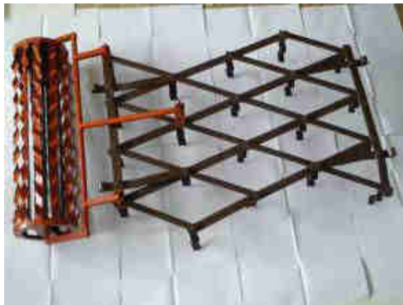
Рис. 1. Комбіноване ґрунтообробне знаряддя для формування передпосівної структури ґрунту: (а) – конструкція комбінованого ґрунтообробного знаряддя; (б) – технологічний процес роботи комбінованого котка
