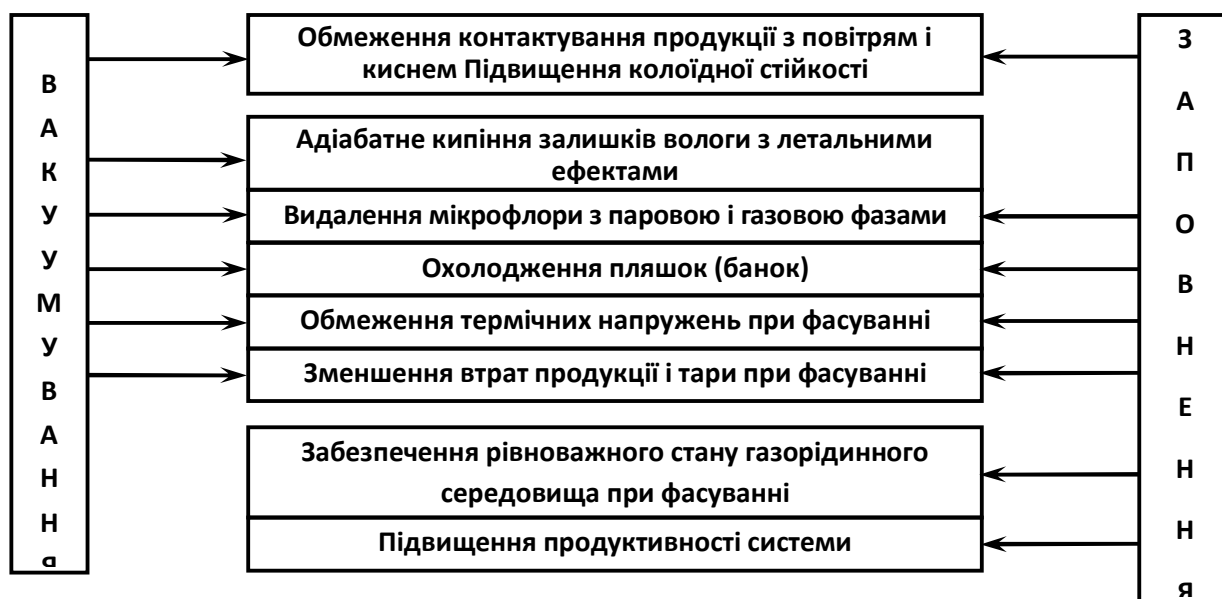
Рис. 1. Схема до визначення сукупності фізичних впливів на скляну тару в режимі передфасувальної обробки.
