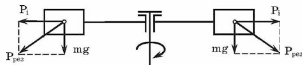
Рис. 1. Схема до визначення силових факторів при обертанні ротора з упаковками
