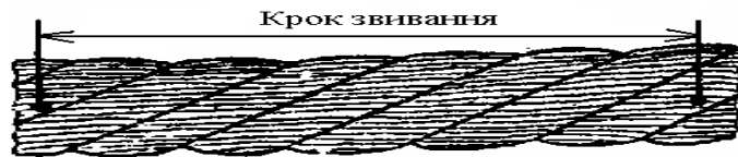
Рис. 1. Крок звивання канатів
