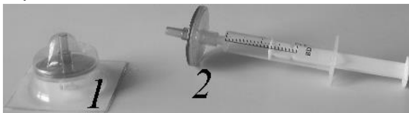
Рис. 9. Мікрофільтр для стерилізації розчинів: 1 – мікрофільтр в стерильній упаковці; 2 – мікрофільтр і шприц перед фільтруванням
