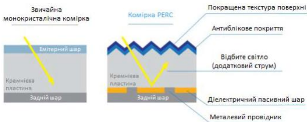
Рисунок 1.4 – Різниця між принципом роботи монокристалічного та PERC фотомодуля [6]
