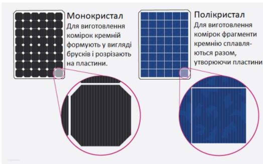
Рисунок 1.3 – Зовнішня різниця між моно- та полікристалічними сонячними панелями [5]
