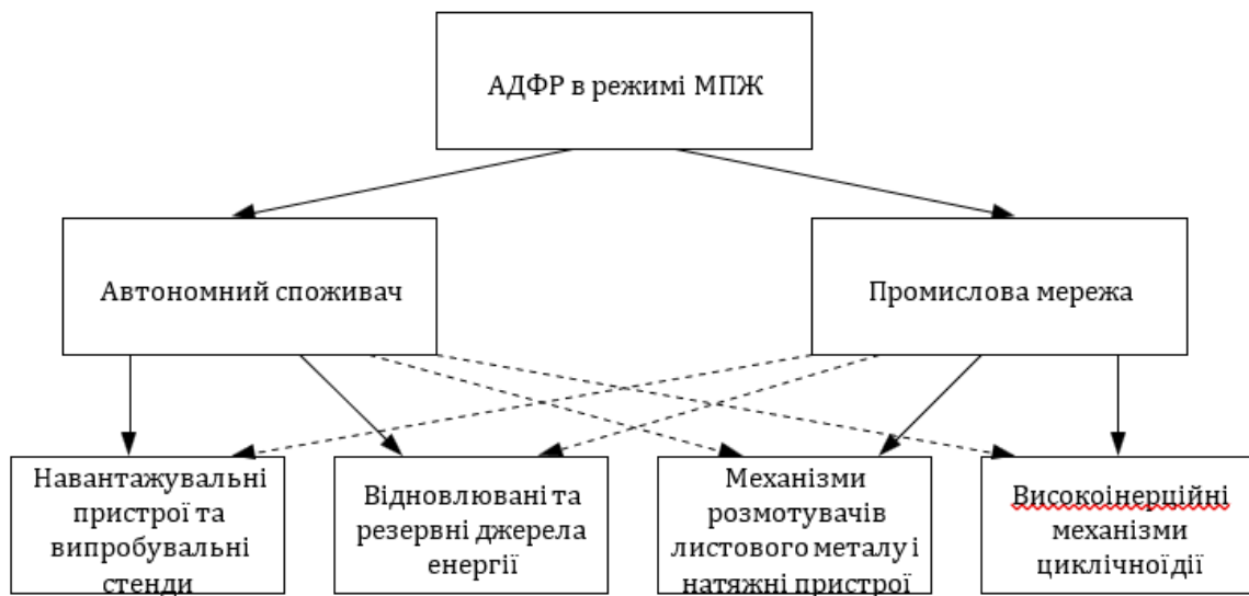
Рисунок 1.6 – Класифікація електромеханічних перетворювачів енергії з урахуванням МПЖ
