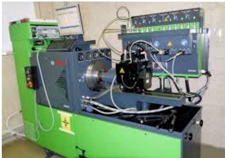
Рисунок 3.4 - Стенд EPS 815 з безмензурочною електронною вимірювальною системою КМА 802 та дооснащенням для СР: 1 - вимірювальна система КМА 802; 2 - форсунки; 3 - комплект дооснащення; 4 - паливний насос високого тиску; 5 - блок керування з дисплеєм вимірювальною системою КМА
