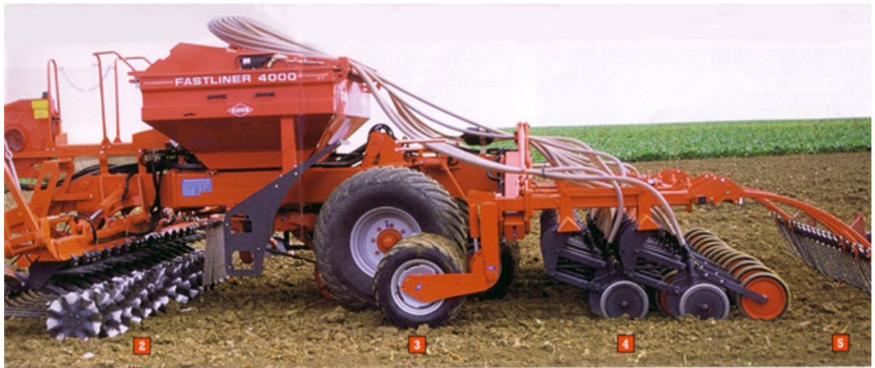
Рисунок 1.5 - Процес посіву по технологіям мінімальної обробки поля сівалкою SD-4000 фірми „KUNN” (Франція)
