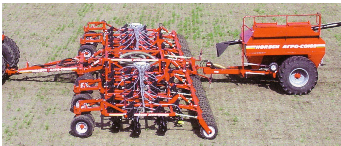
Рисунок 1.4 - Загальний вигляд посівного комплексу АТД-18.3 сумісного виробництва „HORSCH-АГРО-СОЮЗ” (Німеччина-Україна)
