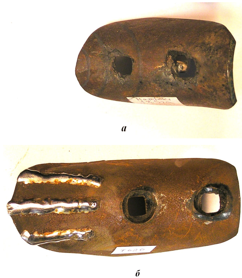
Рисунок 3.3 - Дослідні зразки наральників (наробіток 20га) для проведення енергетичної оцінки: а – серійний; б – зміцнений (зубчастої форми).
