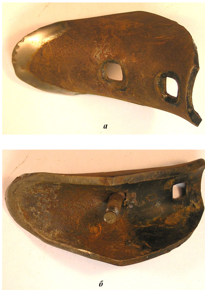
Рисунок 4.7 - Сошники сівалки СТС-2 зміцнені безперервним шаром наплавлю ПГ-С1: а – зовнішнє покриття; б – внутрішнє покриття.
