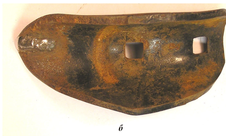
Рисунок 4.6 - Зміцнені наральники сівалки СТС-2:
