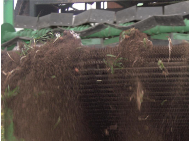
Рис. 4.12. Модернізований робочий орган виносної сепарації в роботі: 1 – каскадний конвеєр; 2 – теребильний пристрій; 3 – додатковий конвеєр; 4 – прямоточна сепаруюча гірка
