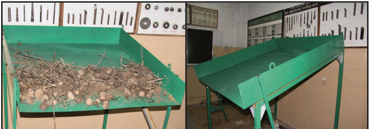
Рис. 3.3. Ємність для попереднього розміщення і подачі вороху на поверхню органу виносної сепарації
