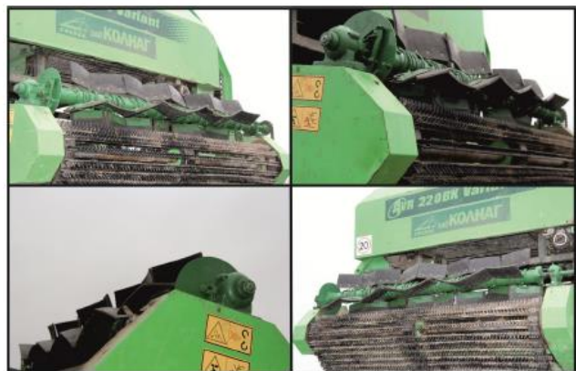
Загальні види бульбовідбивача вдосконаленої картоплезбиральної машини AVR 220 BK Variant:
