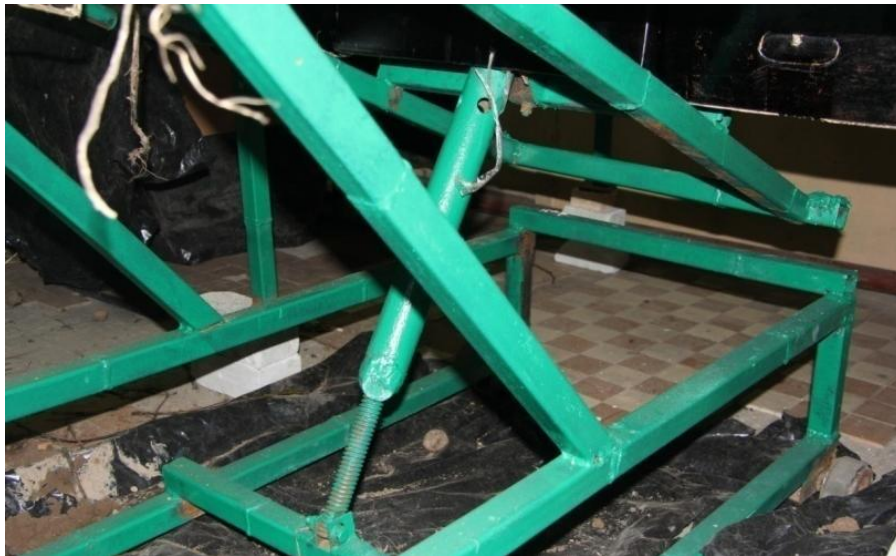
Рис. 3.8. Регулювальний механізм зміни кута нахилу поздовжньої прямої пальчастої гірки
