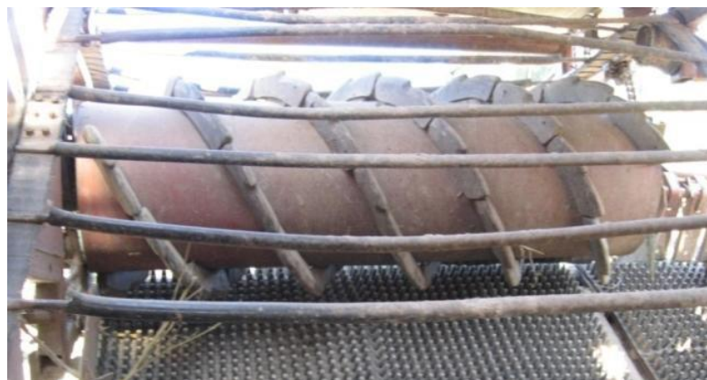
Рис. 1.13. Загальний вигляд органу вторинної сепарації картоплезбирального комбайна КПК-2-01
