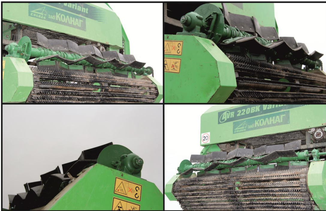
Рис. 4.8. Загальні види бульбовідбивача вдосконаленої картопле-збиральної машини AVR 220 BK Variant:
