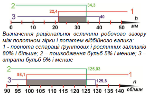
Визначення раціональної величини частоти обертання лопатевого відбійного валика органу виносної сепарації
