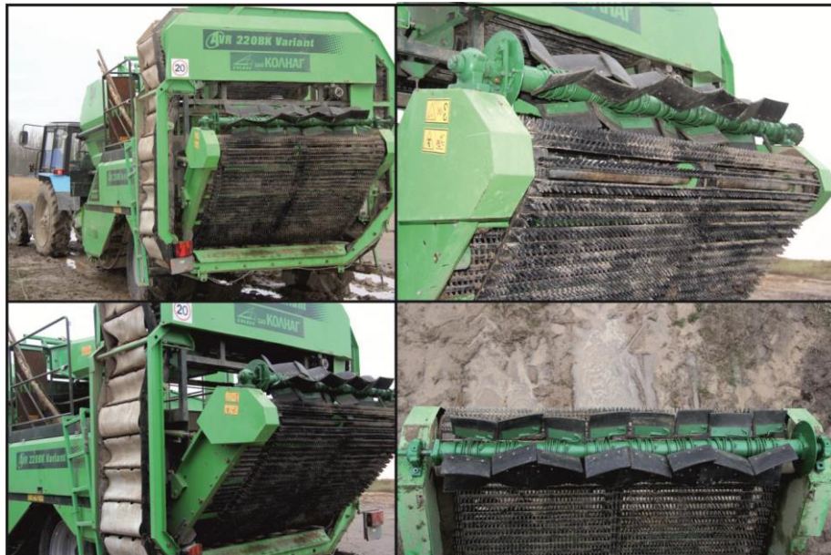
Рис. 4.10. Модернізований робочий орган виносної сепарації вдосконаленого картоплезбирального комбайна AVR 220 BK Variant
