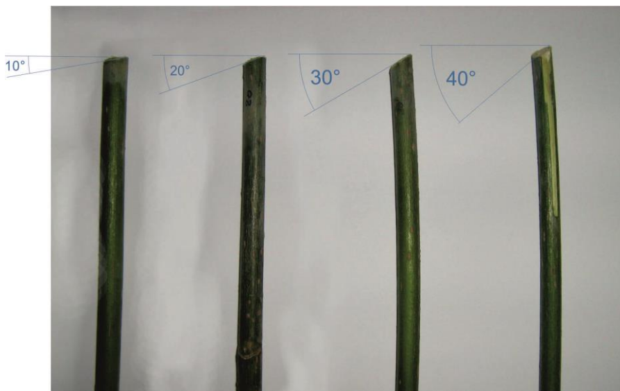
Рис. 3.6. Моделі стебел рослин з кутами зрізу 10^\circ , 20^\circ , 30^\circ і 40^\circ , підготовлені для експерименту
