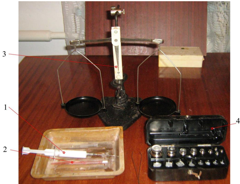
Рис. 3.7. Обладнання для визначення коефіцієнта поверхневого натягу робочого розчину: 1 - шприц; 2 - капілярна трубка; 3 - ваги; 4 - набір вантажів
