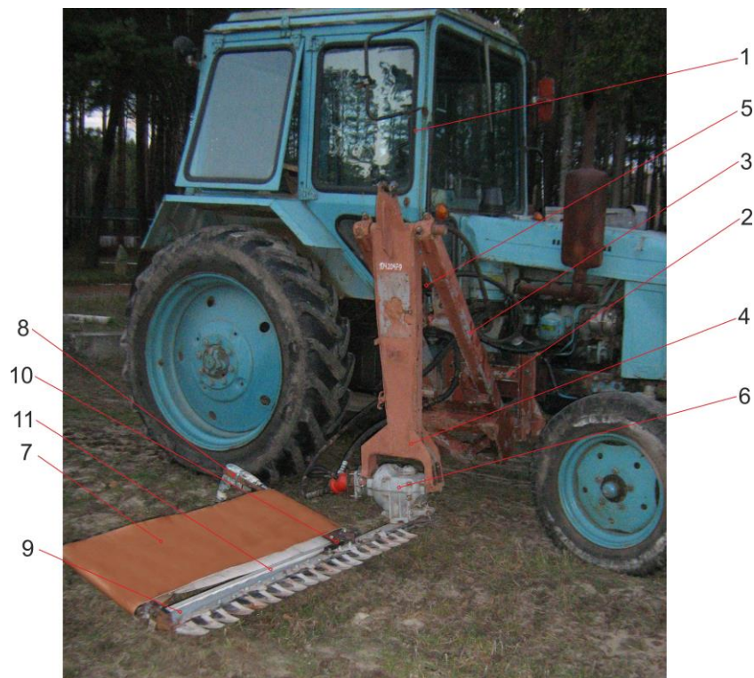
Рис. 3.12. Дослідний зразок машини контактної дії для знищення бур'янів:
