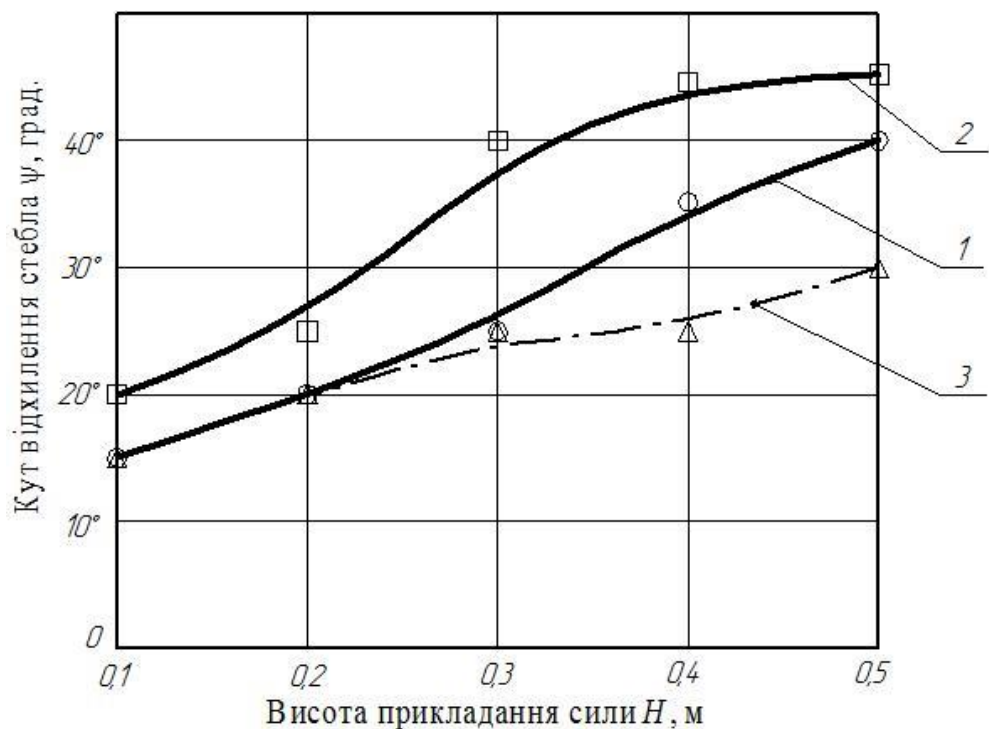
Рис. 4.4. Залежність величини кута відхилення стебла будяка від висоти прикладання сили: 1 - стебло діаметром 5 мм; 2 - стебло діаметром 7 мм; 3 - стебло діаметром 10 мм
