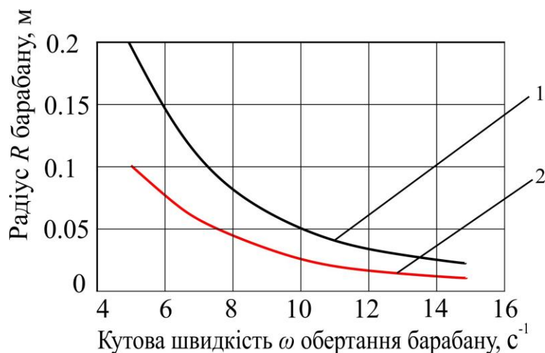
Рис. 2.5. Зв'язок радіусу барабана з його кутовою швидкістю:
