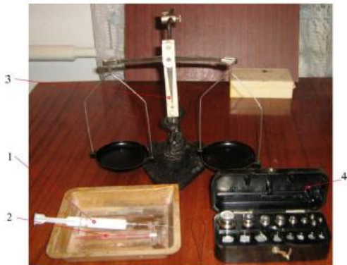
Обладнання для визначення коефіцієнта поверхневого натягу робочого розчину: 1 – шприц; 2 – капілярна трубка; 3 – ваги; 4 – набір вантажів.
