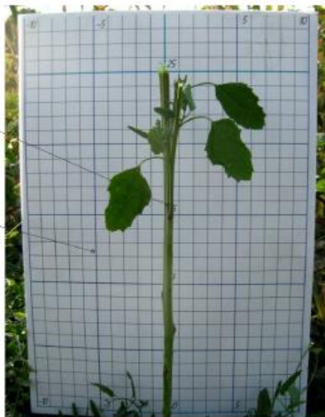
Визначення прискорення верхівки зрізаного стебла рослини: 1 – стебло рослини; 2 – аркуш паперу з сіткою.
