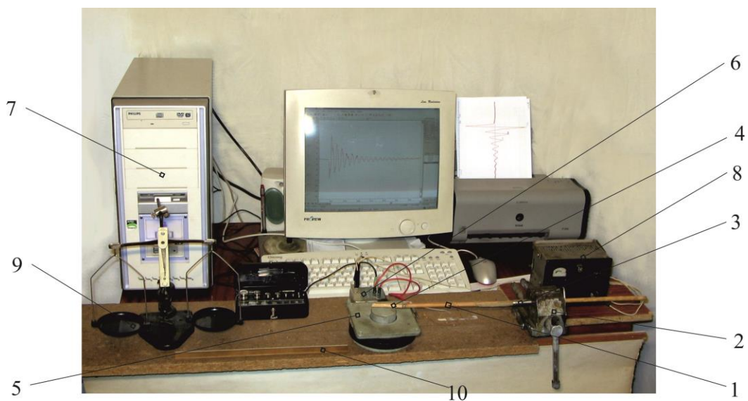
Рис. 3.1. Установка для дослідження пружних властивостей стебел рослин:
