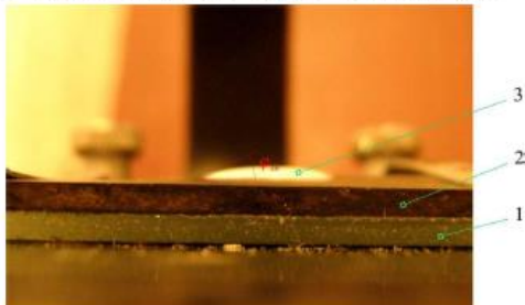
Визначення крайового кута змочування: 1 – підкладка поверхні стола; 2 – досліджуваний матеріал; 3 – крапля робочого розчину.
