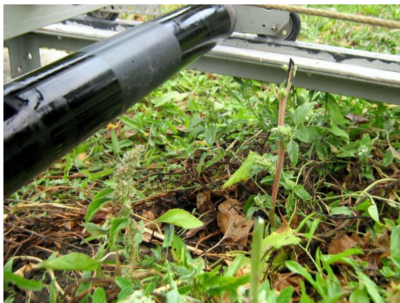
Рис. 4.19. Взаємодія барабана з стеблами, що мають косий зріз
