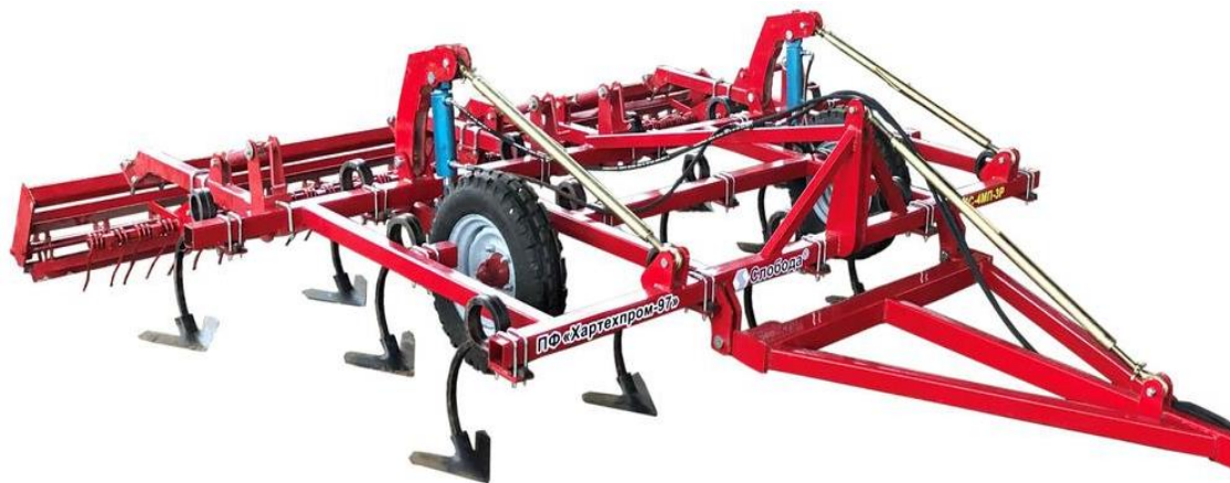
Рисунок 1.2. Культиватор КПС-4МПР Основні технічні характеристики: ширина обробки - 4000 мм; глибина обробки - 50 - 150 мм; максимальна робоча швидкість - 10 км/год; максимальна продуктивність - 4 га/год; техніка, з якою агрегується - трактор від 80 л.с.
