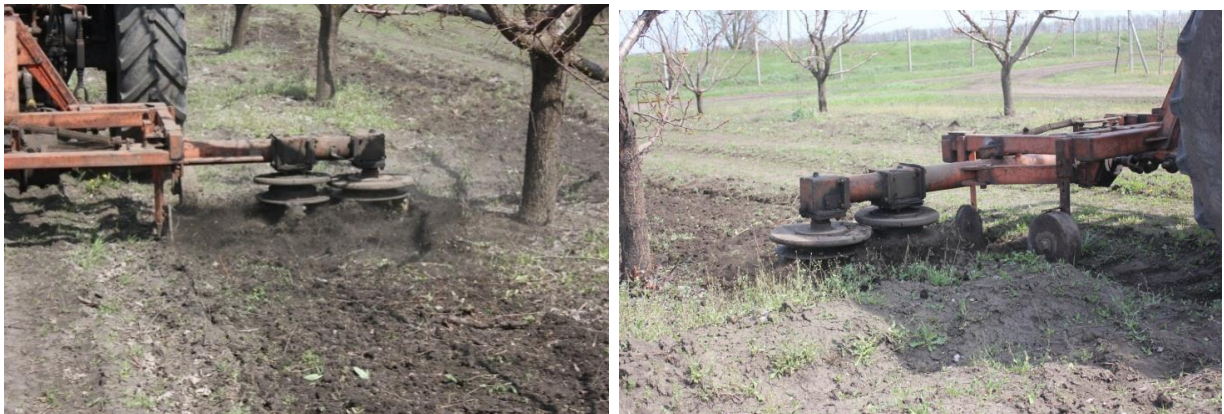
Рис. 4.4. Обробіток ґрунту в пристовбурній смузі фрезерною машиною МФ-1М з експериментальними робочими органами
