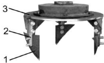
Рис. 1. Ножовий ротор фрезерної машини: 1 - ніж; 2 - стійка ножа; 3 - диск
