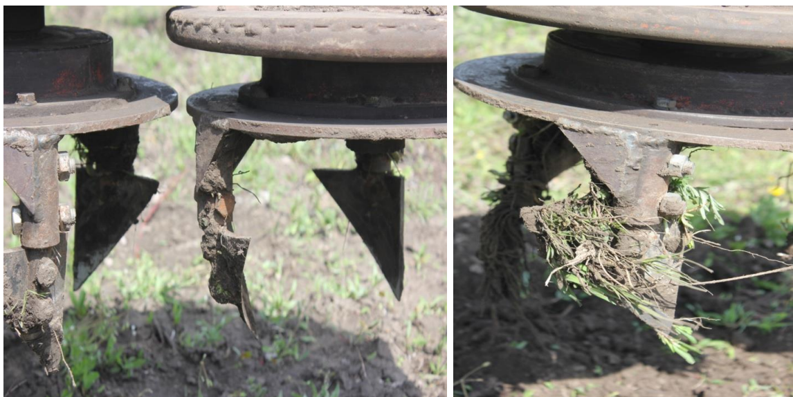
Рис. 4.6. Забивання рослинними рештками і злипання ґрунтом робочих органів
