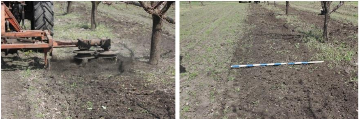
Рис.1. Обробіток ґрунту в пристовбурній смузі фрези МФ-1М з експериментальними робочими органами
