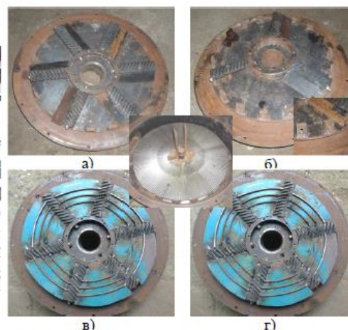
Загальний вигляд виконання нерухомого диска: а, б, в, г – відповідно, варіант 1, 2, 3, 4
