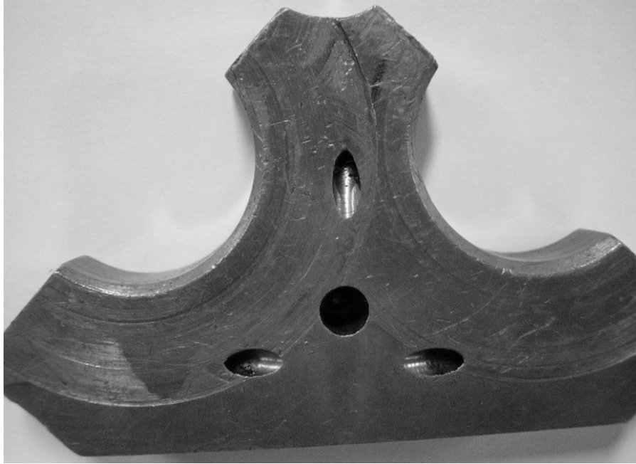
Рисунок 4.1 - Візуалізація деградації торцевої поверхні ушільнювача
