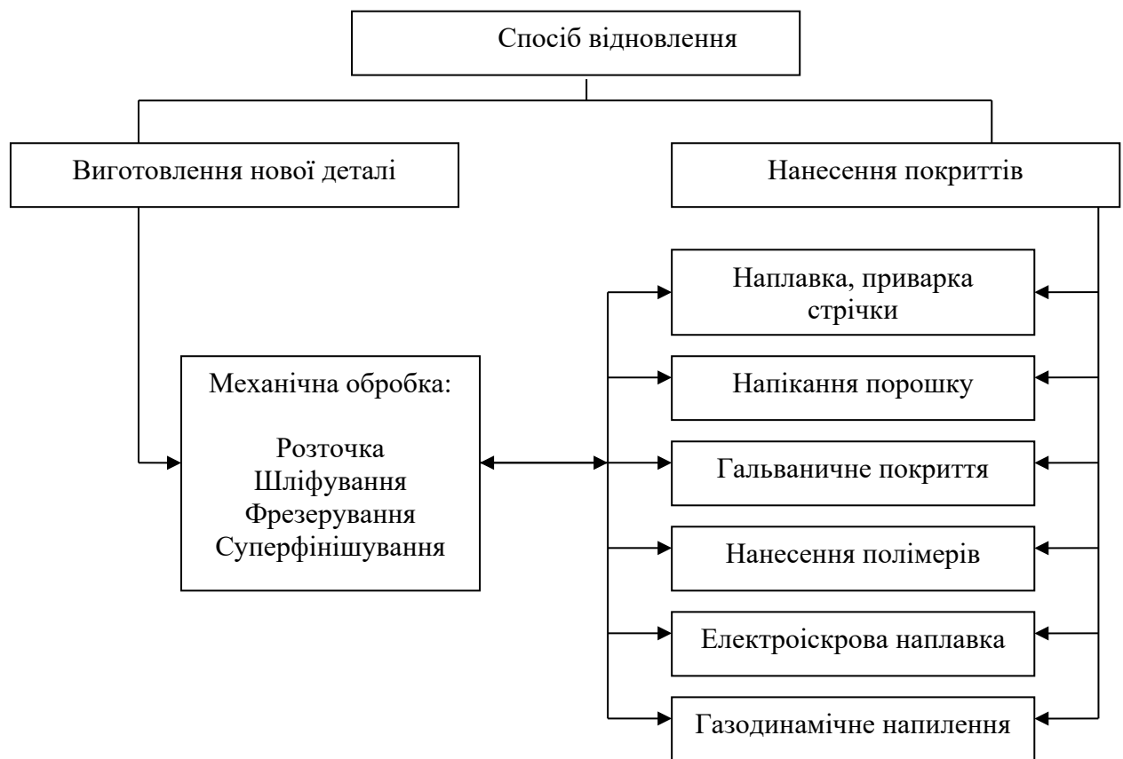
Рисунок 1.2 – Основні способи відновлення шестеренних насосів
