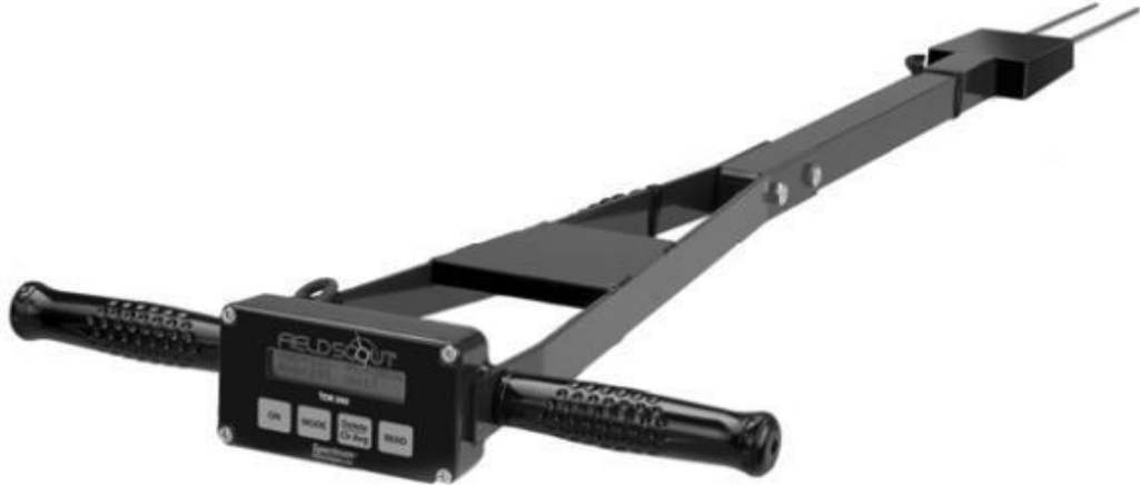
Рис. 3.3 Вологомір FIELDSCOUT TDR 300 Soil
