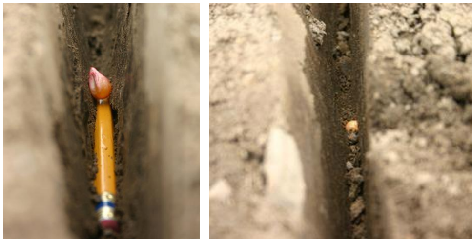
Рис. 1.7 Зображення насінини в борозні: а – до; б – після проходження полозка Keeton Seed Firmer від «Precision Planting»
