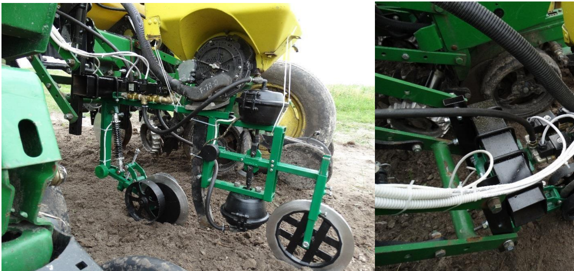
Рис. 3.10 Пропонована сошникова система на сівалці John Deere 7000: а – загальний вигляд; б – кріплення
