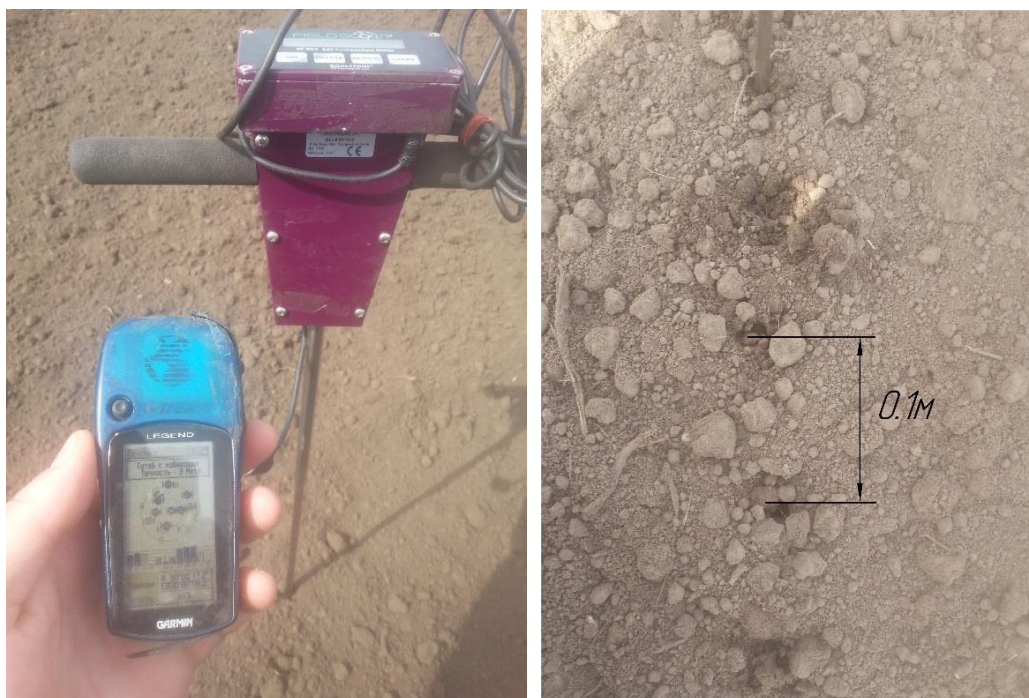
Рис. 4.3 Робота із пенетрометром FIELDSCOUT SC 900 в лабораторно-польових умовах
