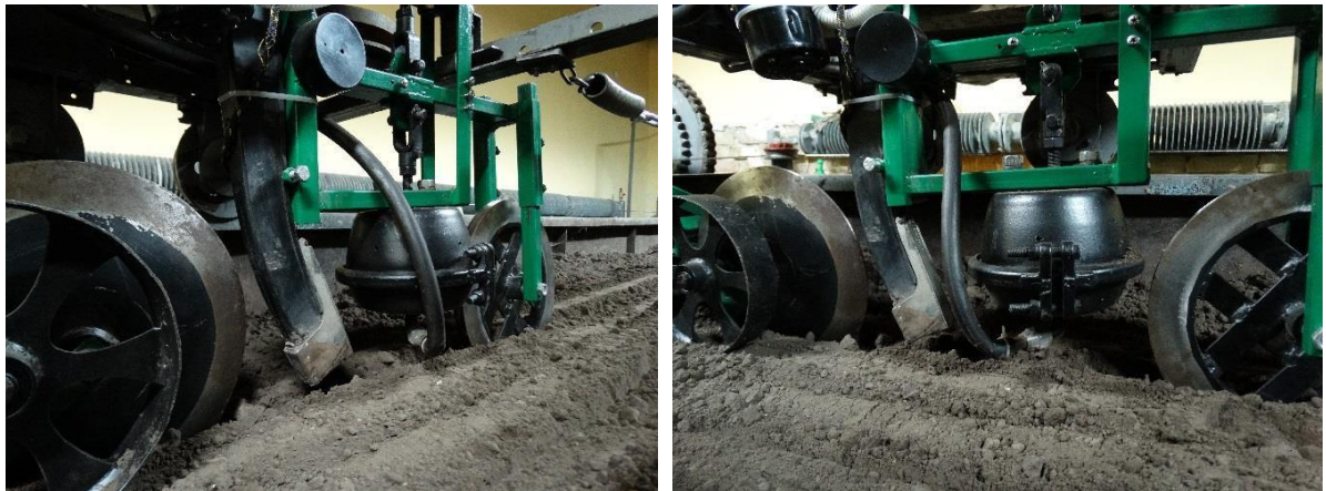
Рис. 3.8 Загальний вигляд двофазної сошникової системи на ґрунтовому каналі
