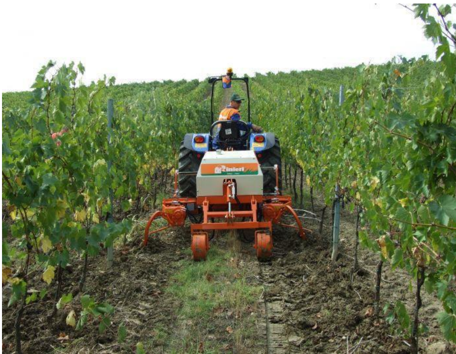
Рисунок 1.21 – Обробіток пристовбурних смуг у виноградниках фрезою E-DUE італійської фірми «RINIERI».
