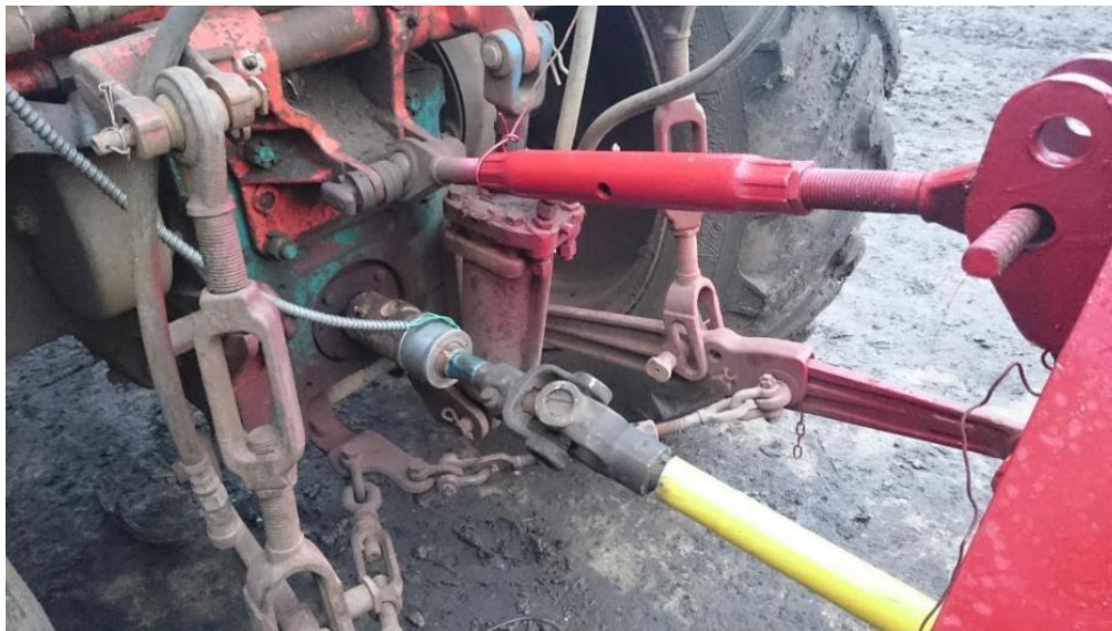
Рисунок 3.9 – Монтаж вимірювача крутного моменту на вал відбору потужності (ВВП) трактора.
