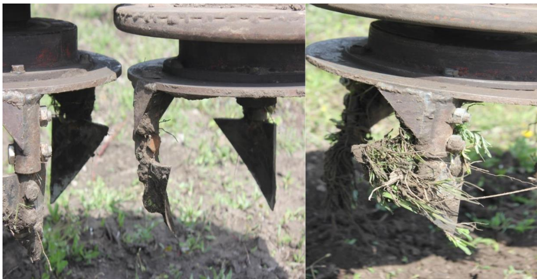
Рисунок 4.6 – Накопичення рослинних залишків та злипання ґрунту на робочих органах.
