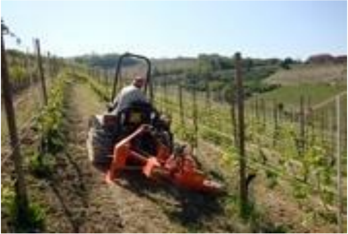
Рисунок 1.16 – Фреза серії EL італійської компанії «RINIERI» під час обробітку пристовбурних смуг у плодovих насадженнях.
