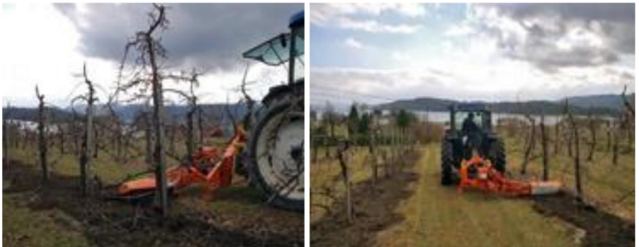
Рисунок 1.12 – Фреза FS італійської компанії «RINIERI S.R.L.» під час обробітку пристовбурної смуги яблуневого саду.
