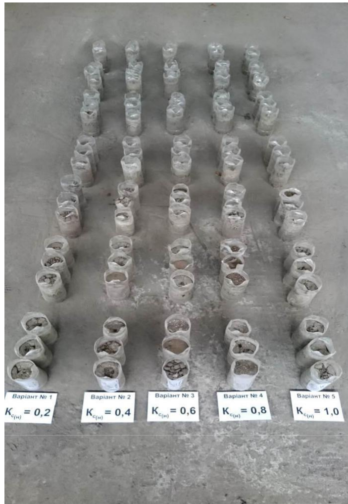
Рисунок 3.1 – Загальний вигляд лабораторних судин, використаних для дослідження змін агрегатного складу ґрунту під впливом води.
