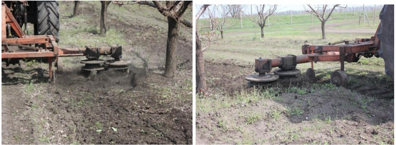
Рисунок 4.4 – Обробка ґрунту в пристовбурній смузі за допомогою фрезерної машини МФ-1М з експериментальними робочими органами.
