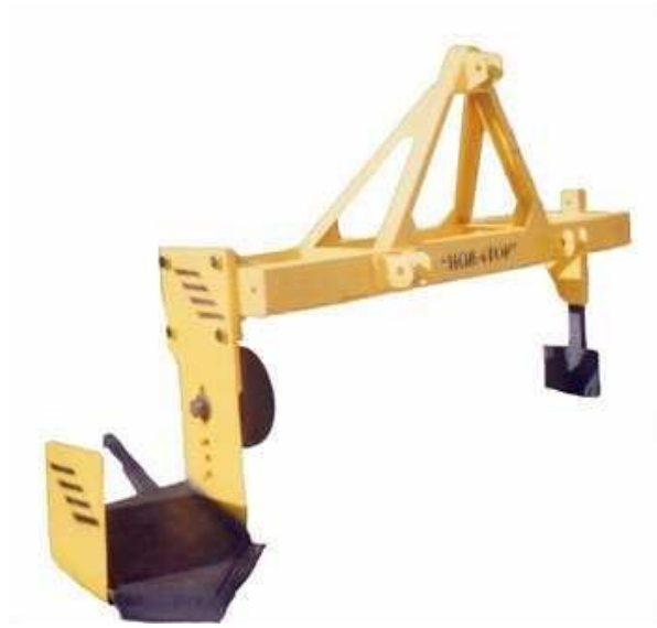
Рис. 1.6. Плуг ВПН-1 для викопування садивного матеріалу.
