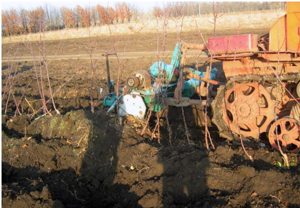
Рис. 4.1. Процес викопування яблуневих саджанців плугом ВПН-2М з експериментальною робочою частиною
