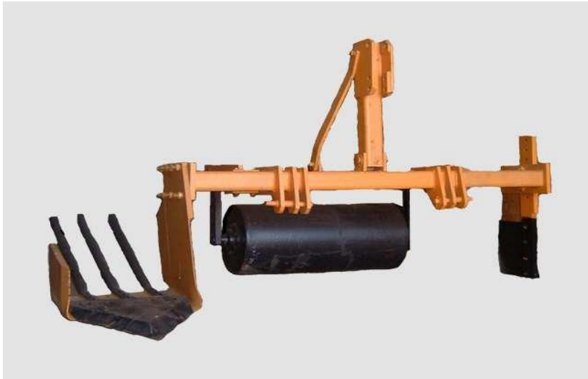
Рис. 1.5. Машина КВ-3 для викорчування виноградних кущів.
