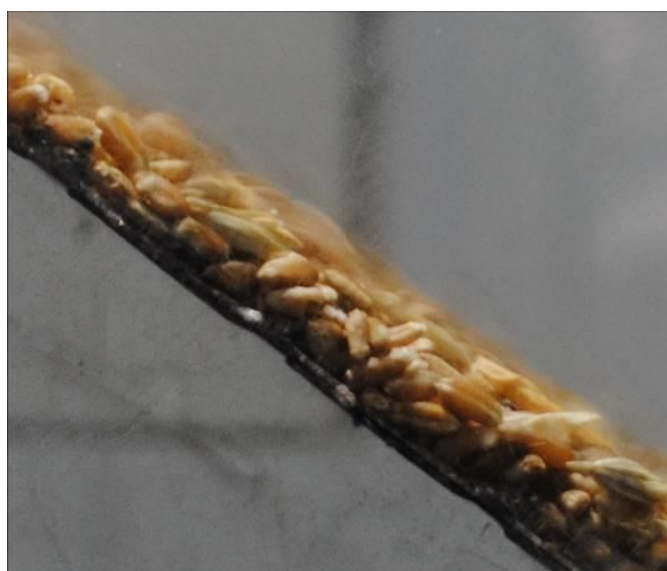
Рисунок 3.15 – Фотографічне зображення процесу розшарування ЗС на повітропроникній лускатій поверхні розробленого ПСК
