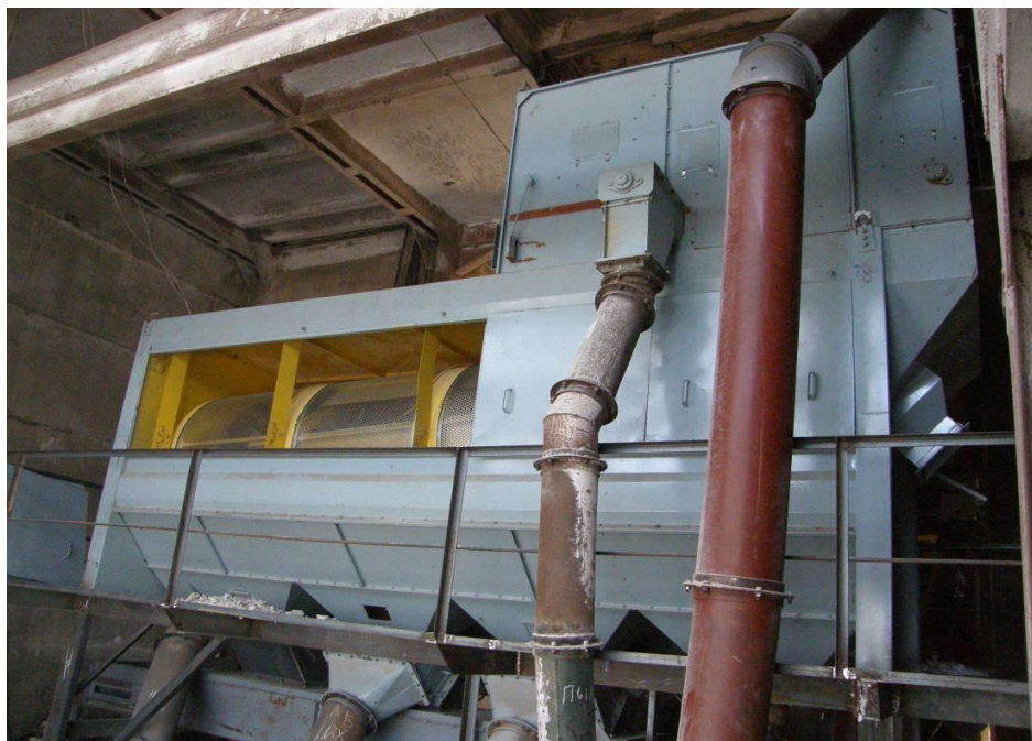
Рисунок 5.2 – Загальний вигляд сепаратора КБС 1270.4.00 з розробленим пневмосепарувальним каналом
