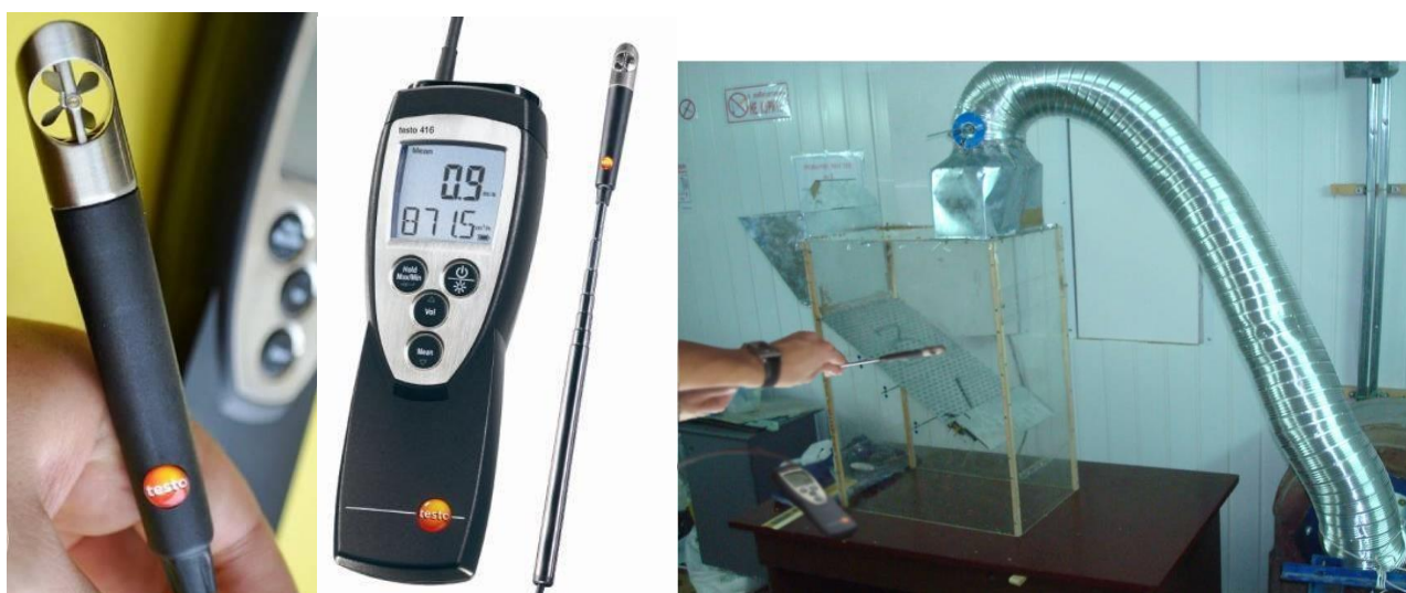
Рисунок 3.5. Використання анемометру Testo 416 для дослідження швидкості повітряного потоку у розробленому ПСК
