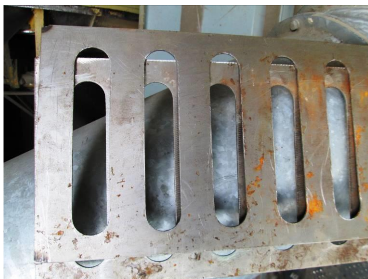
Рисунок 5.7 – Монтаж повітропроникної поверхні та регулювальних жалюзі пристрою розробленого пневмосепарувального каналу
