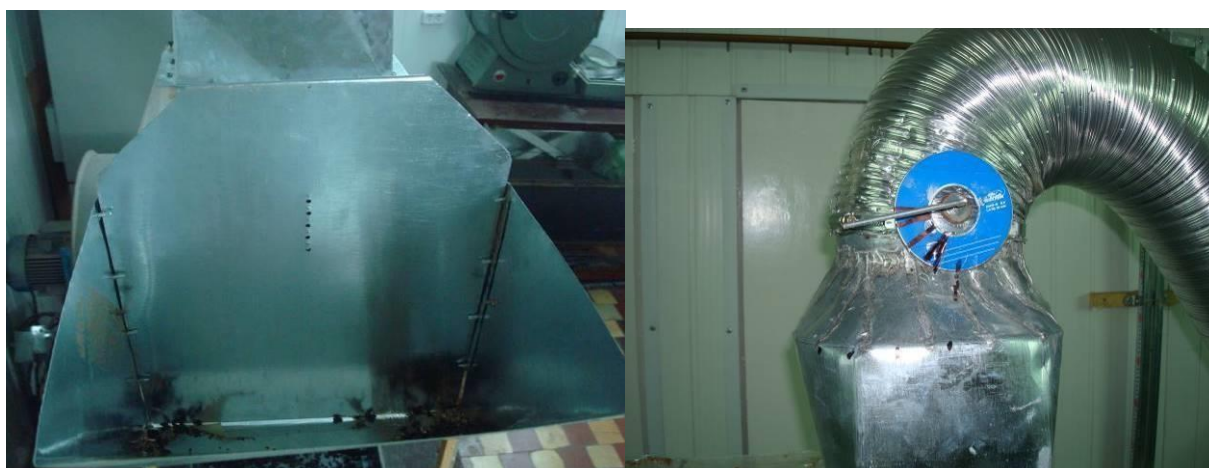
Рисунок 3.2 – Завантажувальний бункер установки з заслінкою та регулювання швидкості повітряного потоку
