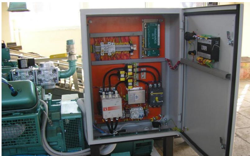
Рисунок 2.9 – Блок керування в ході моторних випробувань дизеля 6Ч13/14
