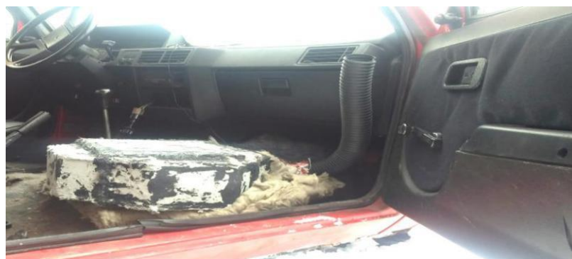
(в) тепловий акумулятор фазового переходу (ТАФП), змонтований у зоні переднього пасажирського сидіння
