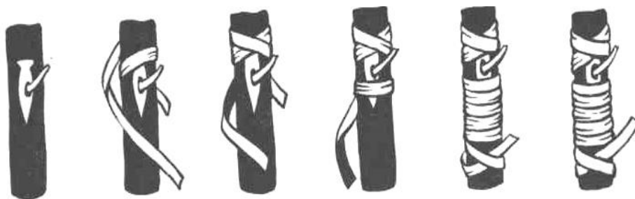
Рис. 13. Послідовність виконання зав'язування щитків
