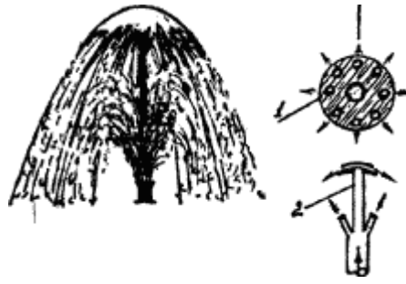
Рис. 187. Фонтан і насадка «тіффані»; 1 - вид насадки зверху; 2 - вид насадки збоку
