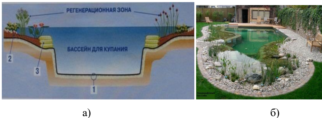
Рис. 6 .а). Схема створення купального ставу; б) фото купального ставу.
