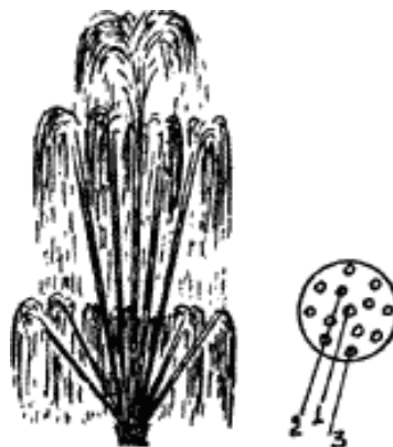
Рис. 23. Фонтан і насадка - «ярусний розпилювач»; 1 - великий напір; 2 - середній напір; 3 - малий напір;
