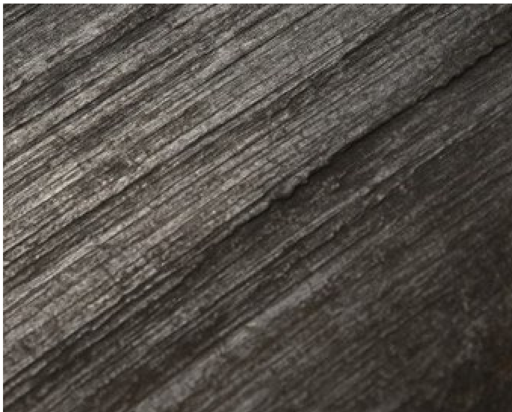
Рис. 1. Поверхня тертя (матеріал сталь 65Г, абразив – кварцовий пісок).
