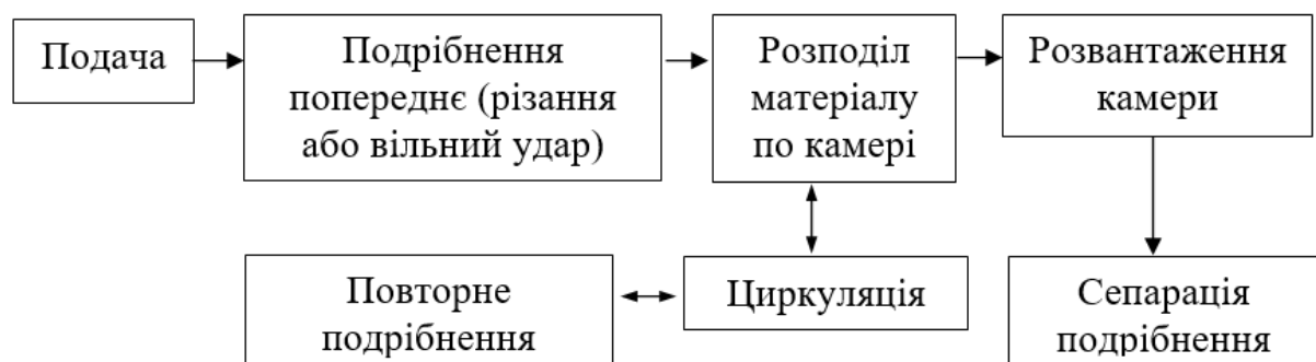
Рисунок 1. Блок-схема роботи подрібнювача з реккатером
