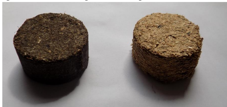
Рис. 1 – Циліндричні деревні брикети з торефікованої (зліва) і необробленої (справа) тирси
