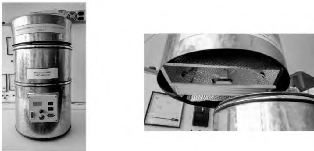
Рис. 1. Загальний вид лабораторного мікронізатора з ECS нагрівачем Fig. 1. General view of a laboratory micronizer with an ECS heater
