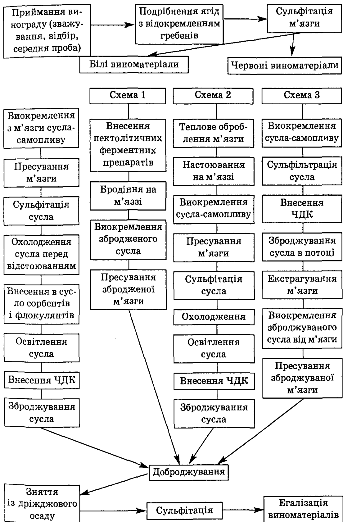
Рис. 21. — Технологічна схема одержання виноматеріалів для натуральних вин
