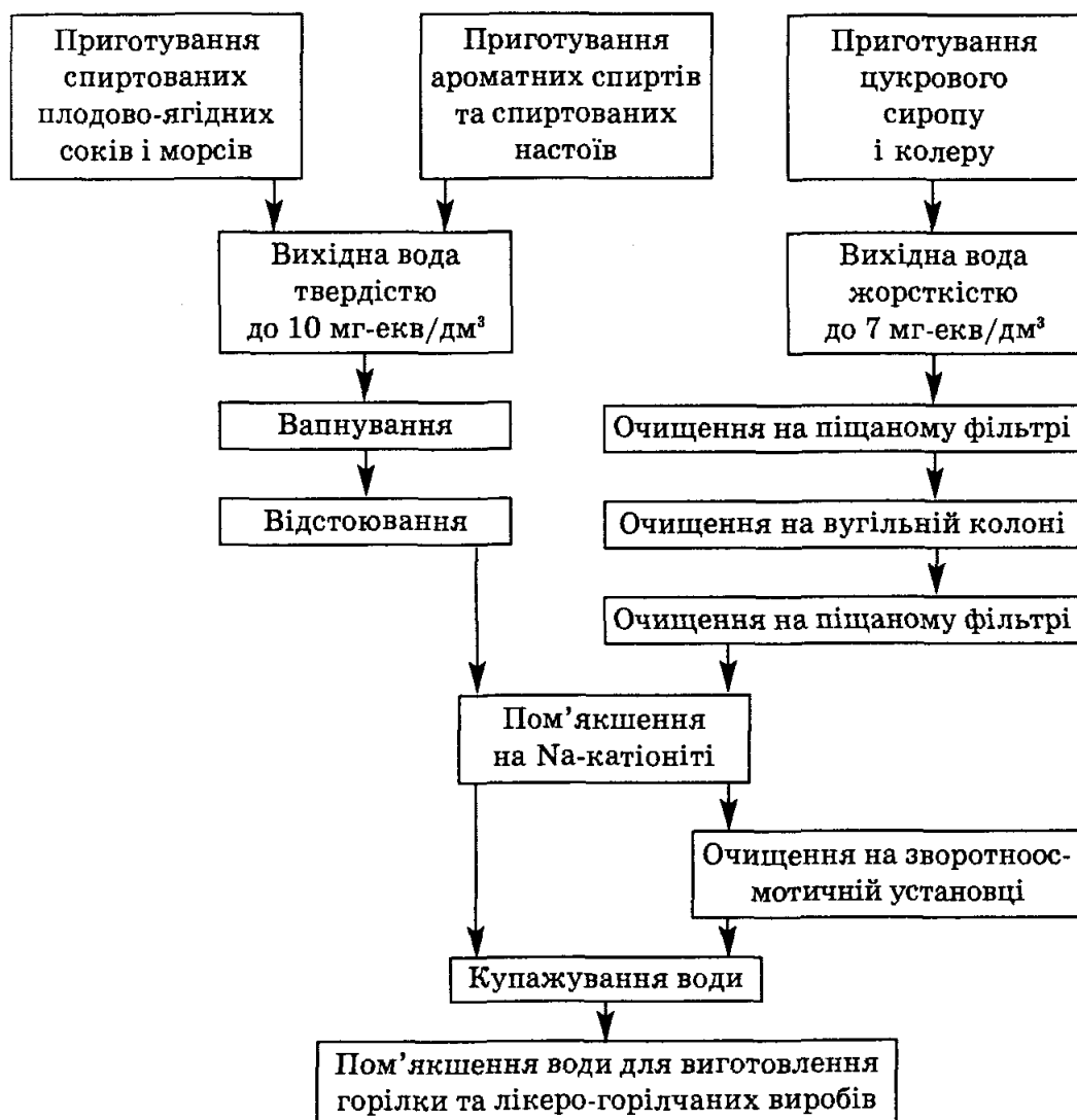
Рис. 20 — Технологічна схема пом'якшення води для горілок і лікero-горілчаних напоїв
