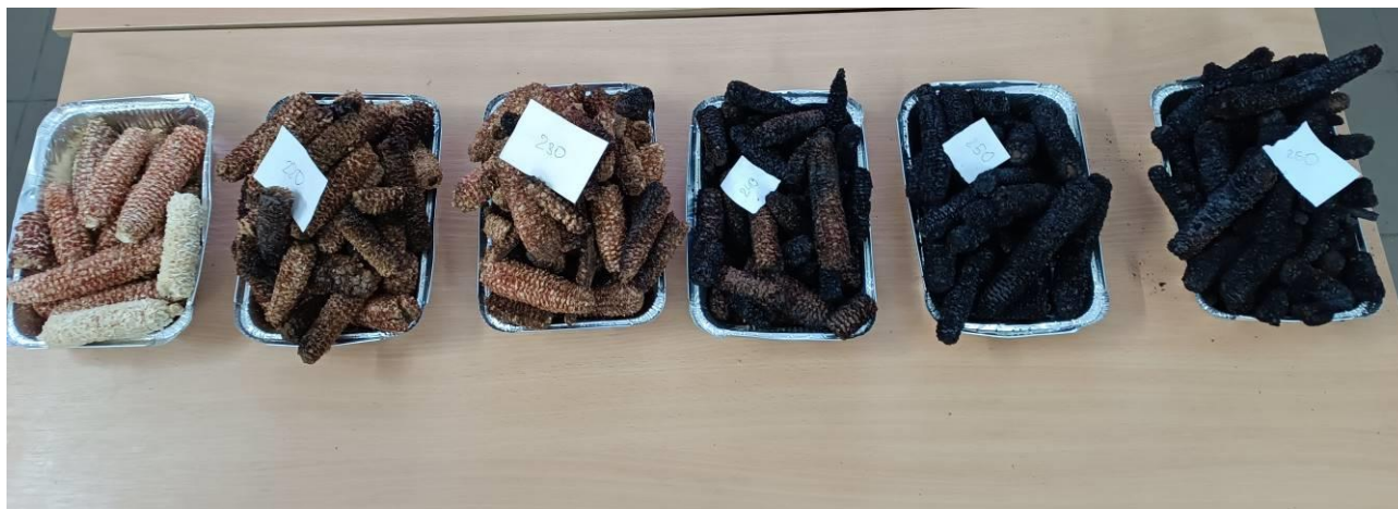
Рис.1. Сирі (зліва) і торефіковані при різних режимах стрижні кукурудзи
