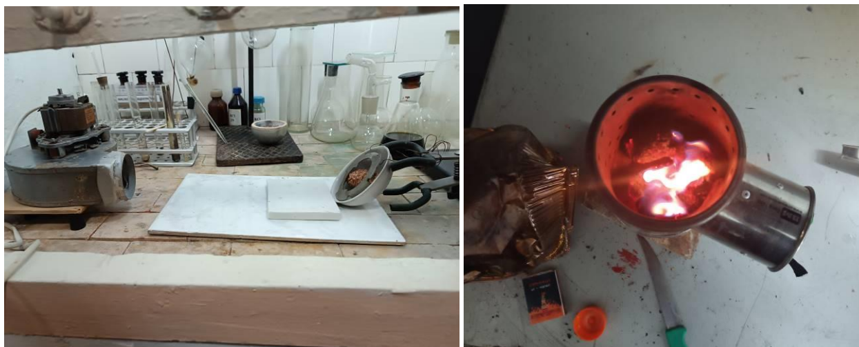
Рис. 2. Спалювання зразків стрижнів кукурудзи в потоці повітря (а) і в полевій пічці (б)
