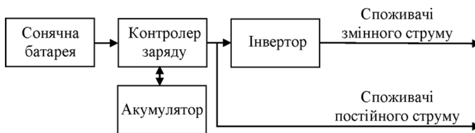
Рисунок 1.1 - Принцип роботи сонячної установки
