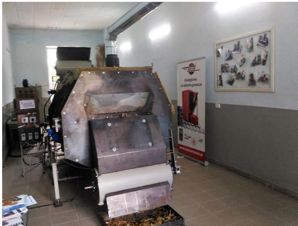
Rys. 2. Instalacja do toryfikacji „DAK GPS”
