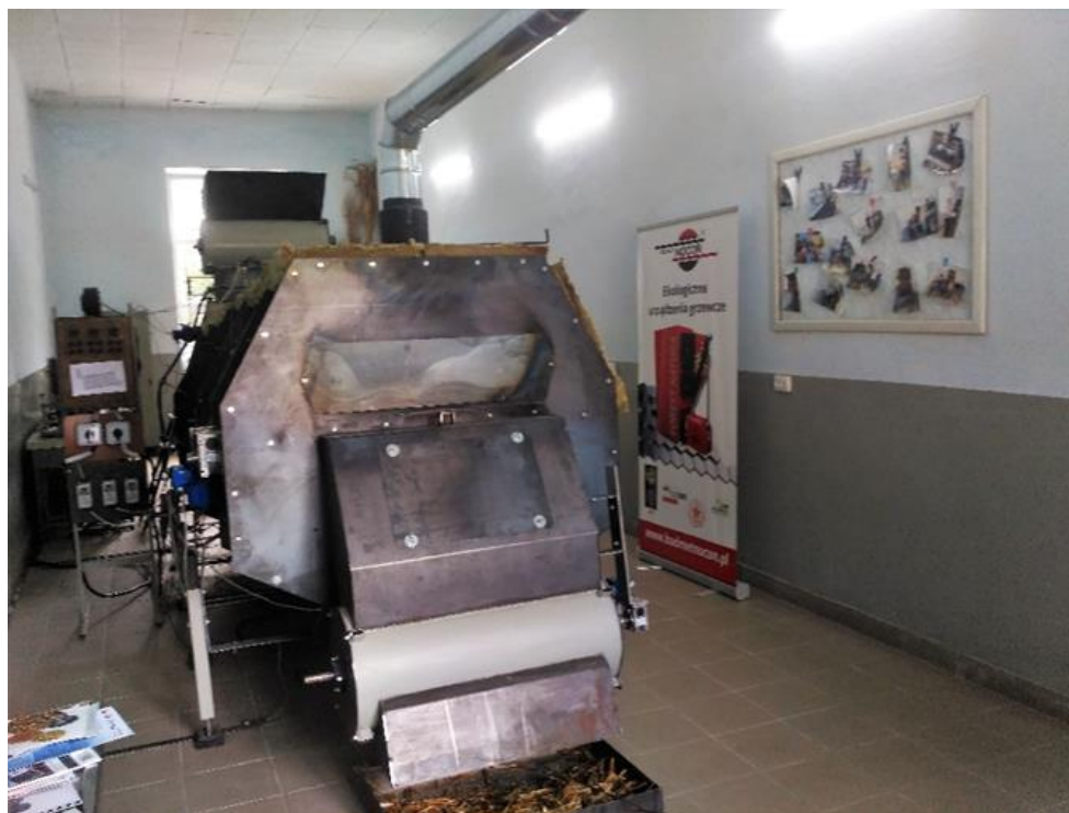
Rys. 2. Instalacja do toryfikacji „DAK GPS”
