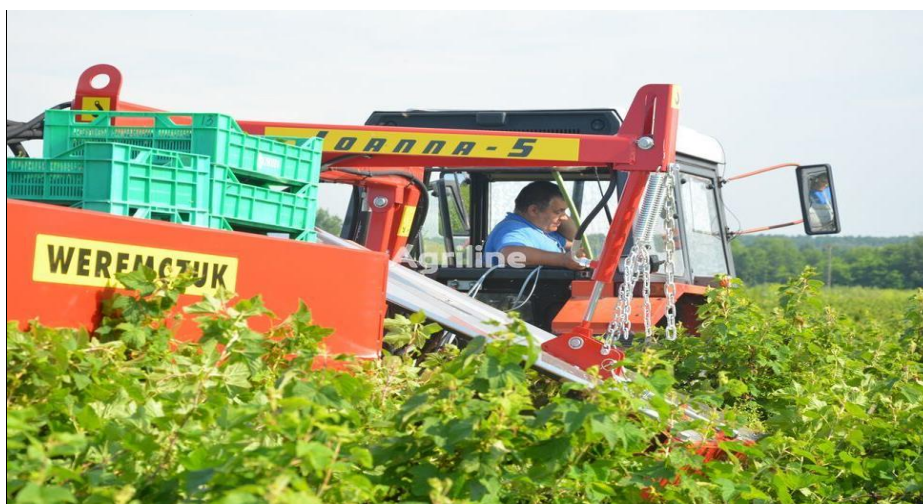
Рис. 4. Комбайн для збору вишень та слив FELIX/Z
