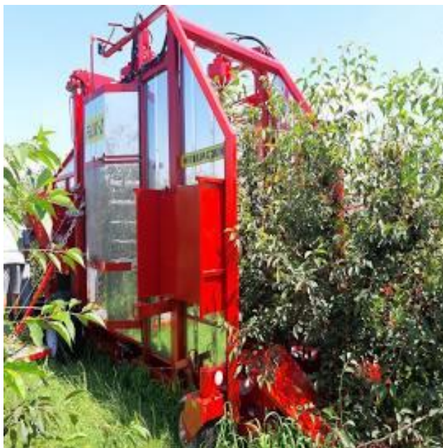
Рис. 4. Комбайн для збору вишень та слив FELIX/Z
