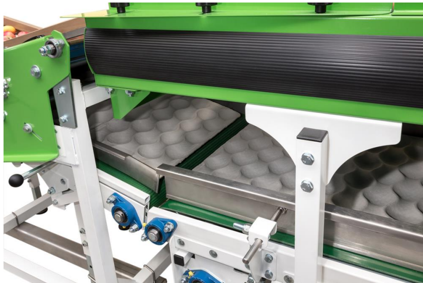
Рис. 7 (а, б, в) Автоматична лінія для пакування фруктів на підкладку (альвеоли) (джерело: https://www.sorter.pl/pl )
