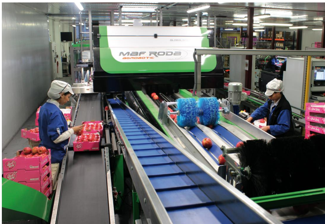
Рис. 8. Лінія товарної обробки яблук MAF RODA (Франція) (джерело: https://www.maf-roda.com/en/page/novacoop-automatic-robot-packing-line.php )
