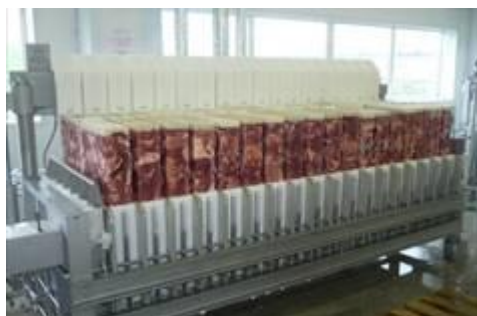
Мал.4. Плиточний швидкоморозильний апарат
